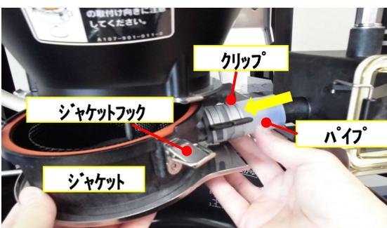
⑤クリップを左にずらし、3か所のジャケット・フックをを外しパイプごとジャケットを取って下さい。
