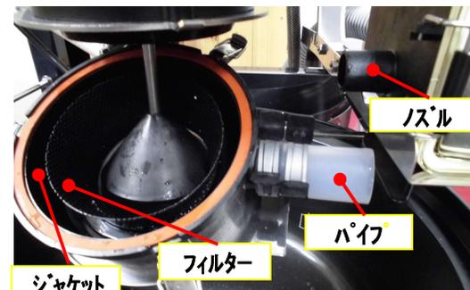
⑥ジャケット内側・フィルター・パイプ・ノズルを付属のブラシで洗って下さい。
