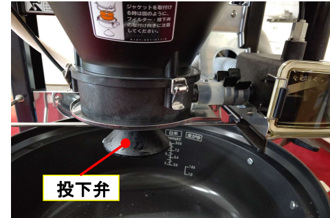
③投下弁が落下します。
