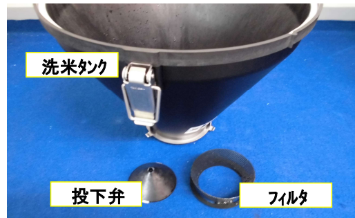
⑩洗米タンク・投下弁・フィルタをスポンジ等で洗って下さい。
