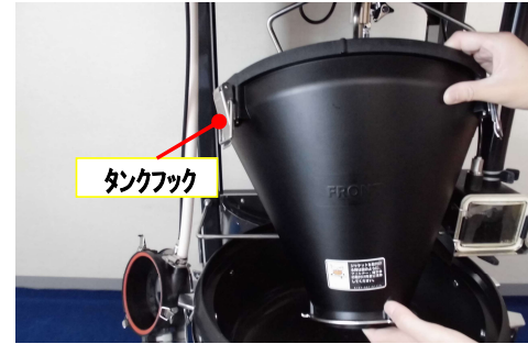
⑦3か所のタンクフックを外し、洗米タンクを外して下さい。
