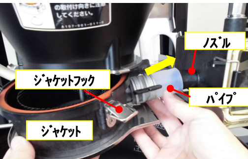
⑦パイプを持ち上げながらノズルに差し込んで下さい。
